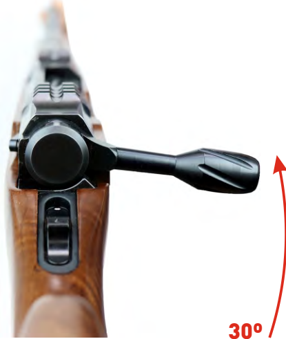
Mekanizma Emniyet Pozisyonu (1. kademe açık olan mekanizma görünümü)
